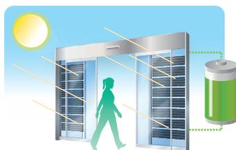
バッテリー内の電気が十分にある場合はその力のみで開閉します。停電時も開閉可能です。
