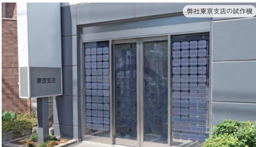
自動ドア建具の範囲で太陽光発電システムが完結します
