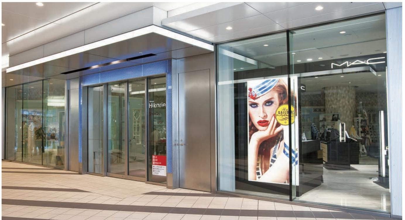
▲LEDライトを引き立たせるため、輝きを抑えたステンレスサッシ(パイブレーション仕上)
