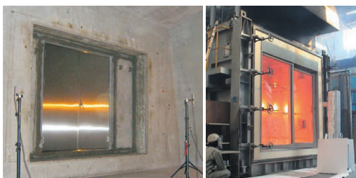
両開き扉枠の遮音試験
