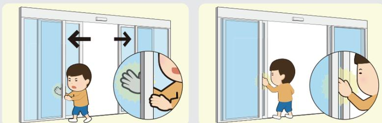
● 開いていく扉と枠の間での引き込まれリスクの低減 ● 全開した扉と枠の間での指挟み防止
